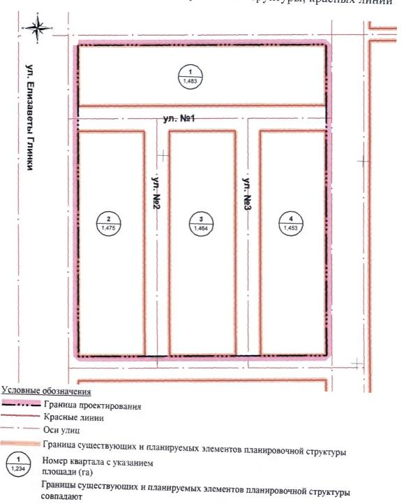
Чертеж планировки территории с отображением границ зон планируемого размещения объектов капитального строительства
