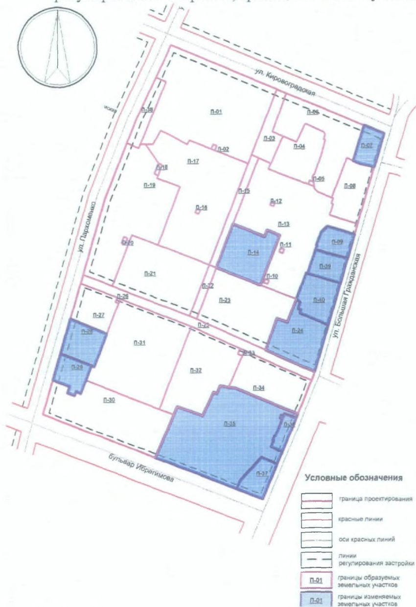
Чертеж межевания территории с отображением красных линий, линий регулирования застройки, границ земельных участков
