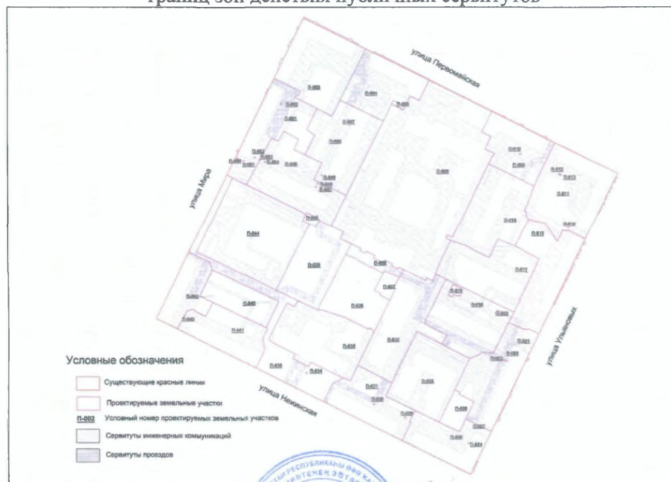
Чертеж межевания территории с отображением красных линий, линий регулирования застройки, границ зон действия публичных сервитутов
