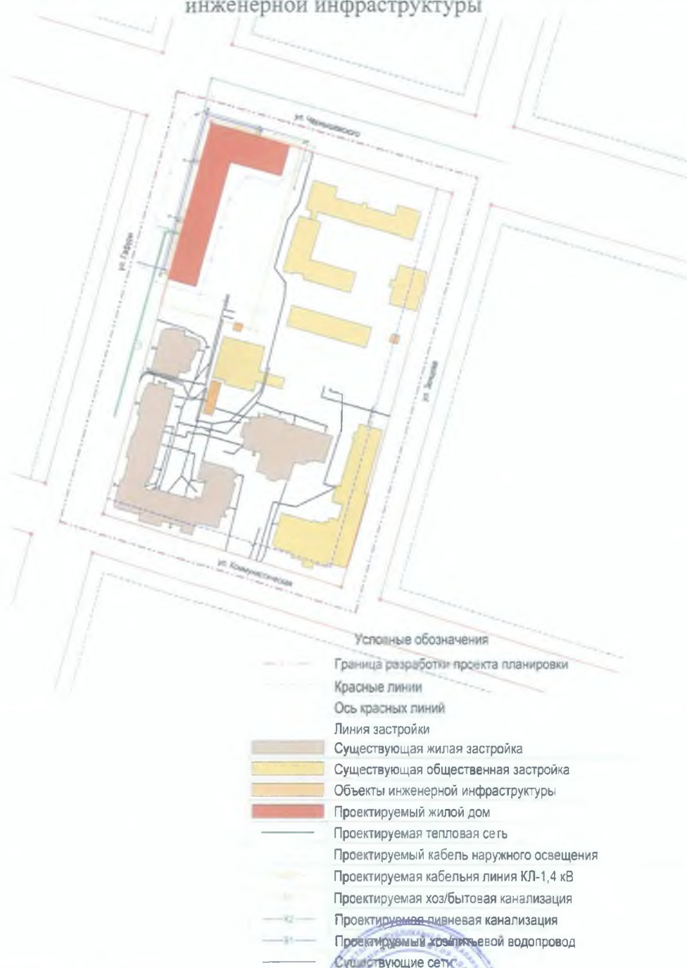
Чертеж планировки территории с отображением красных линий и объектов инженерной инфраструктуры
