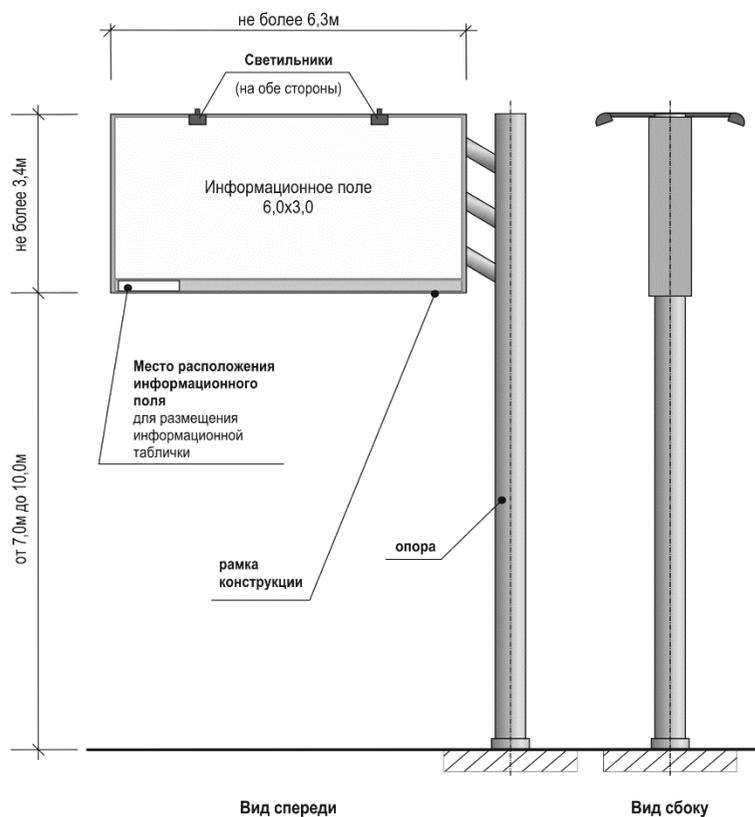
**Тип и вид SNP:** Стационарное средство наружной рекламы, щитовая установка сверхбольшого формата;
