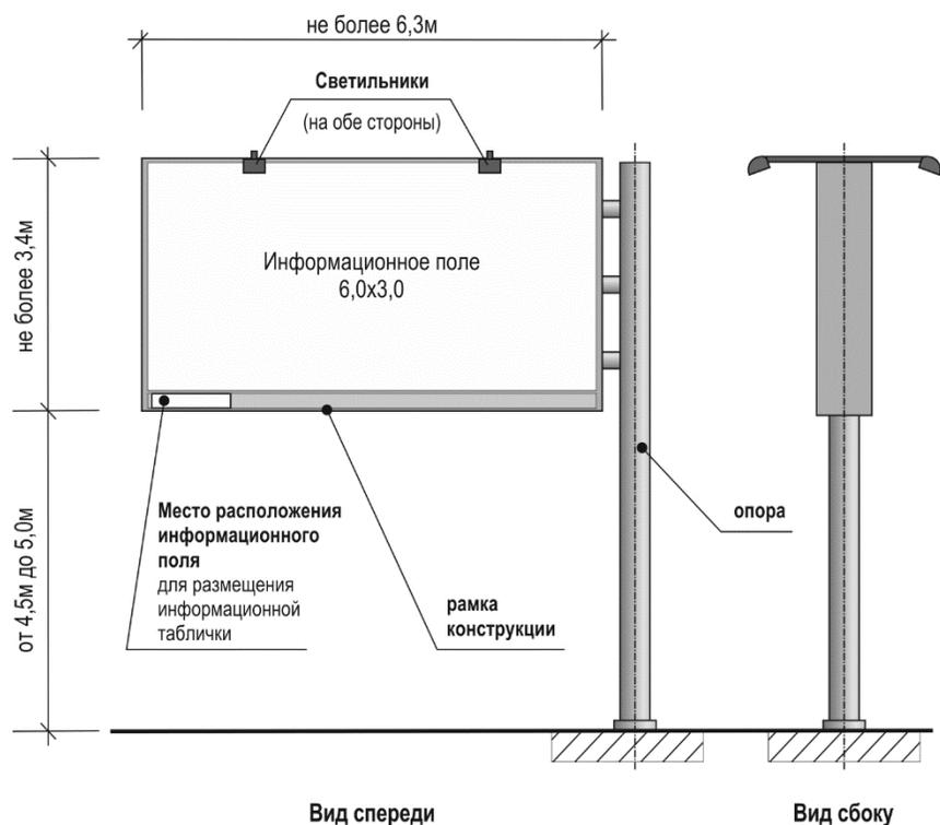
**Тип и вид СНР:** Стационарное средство наружной рекламы, щитовая установка сверхбольшого формата;
