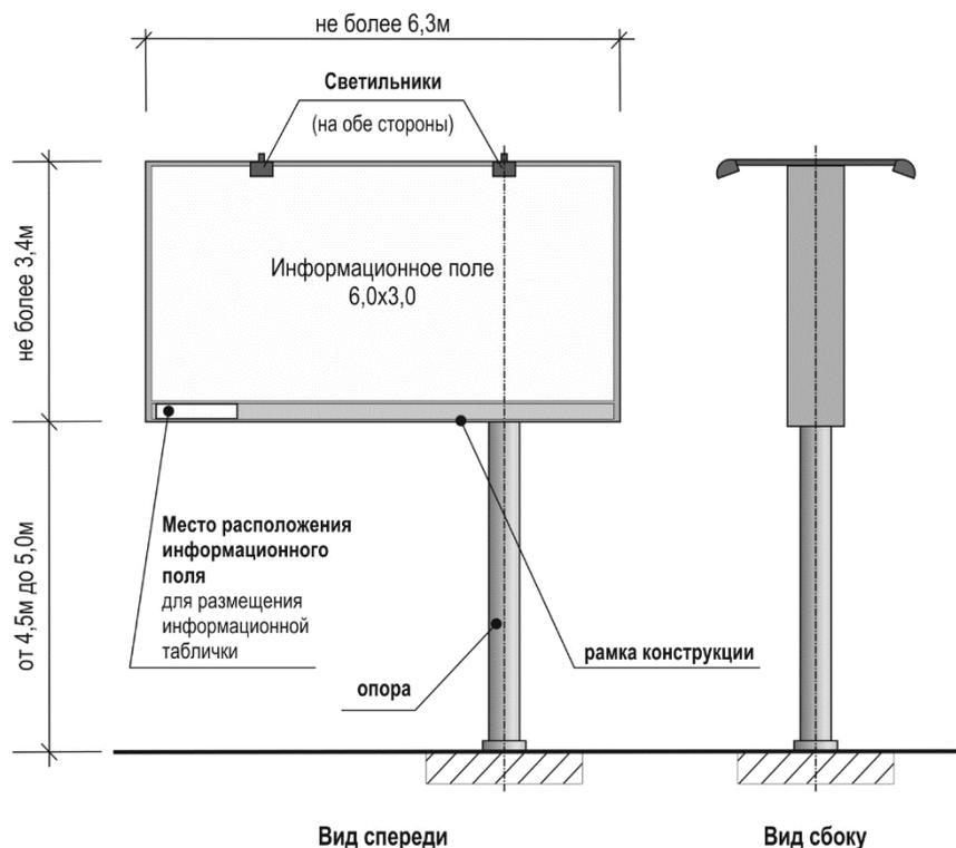
**Тип и вид СНР:** Стационарное средство наружной рекламы, щитовая установка сверхбольшого формата;
